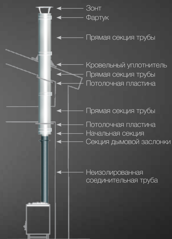
Монтаж с неизолированной соединительной трубой
