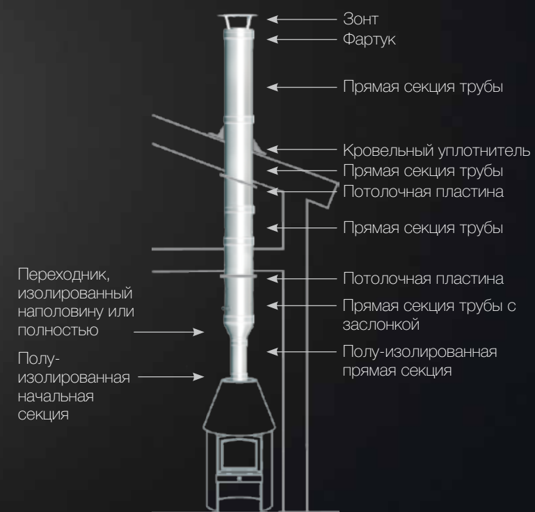
Монтаж сверху камина с полу-изолированной начальной секцией
