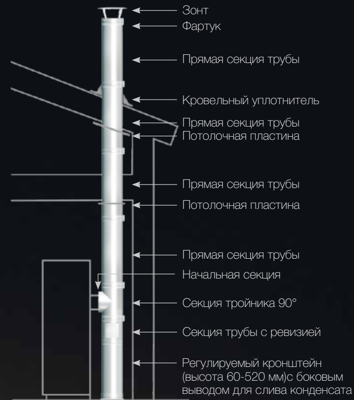
Внутренний монтаж сзади
