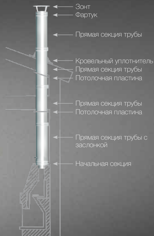
Монтаж сверху камина
